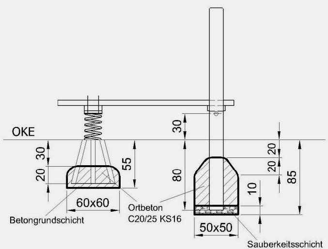
Fundamentköpfe runden mit  $R = \text{min. } 10 \text{ cm}$
